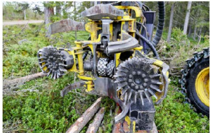
↑ Die schiefen Lamellen von V-Tec befinden sich immer in der gleichen Richtung, d.h. die linken und rechten Rollen sind identisch. Dank der Form ist der Griff in umgekehrte Richtung der Gleiche wie beim Vorwärtsschub. Die V-Tec-Palette deckt die gängigsten Drei- oder Vierwalzen-Harvesteraggregate ab.
